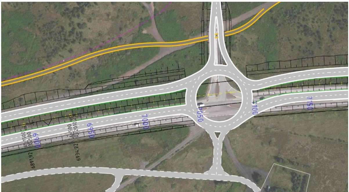
MYND 3.21 Tvöfalt hringtorg á vegamótum við Hafravatnsveg, sem eru hluti af 2. áfanga framkvæmdarinnar.
