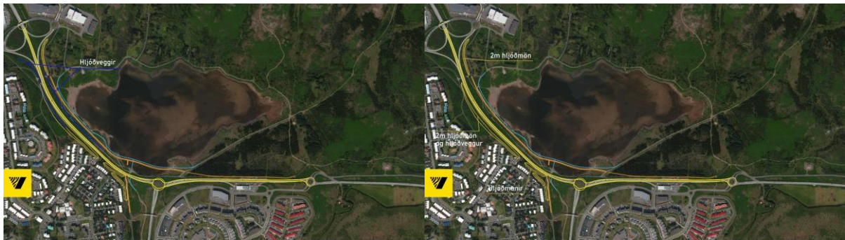
MYND 3.26 Skjáskot úr kynningarmyndbandi Vegagerðarinnar um framkvæmdirnar. Myndin sýnir hljóðmanir og hljóðveggi sem eru hluti af fyrsta áfanga (myndband EFLA, 2021).
